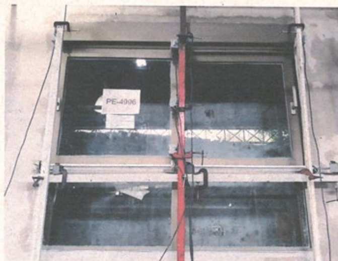
Foto nº 05 Verificação do comportamento quando submetido a cargas uniformemente distribuídas: Posicionamento dos deflectômetros.
