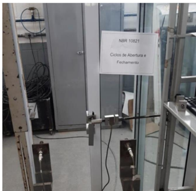
Foto n.º 05 – Visualização do ensaio comportamento sob ações repetidas de abertura e fechamento.
