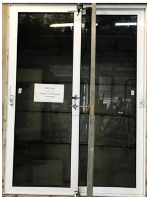
Foto n.º 04 – Visualização do ensaio de comportamento sob cargas uniformemente distribuídas.
