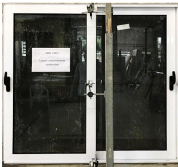
Foto n.º 04 – Visualização do ensaio de comportamento sob cargas uniformemente distribuídas.
