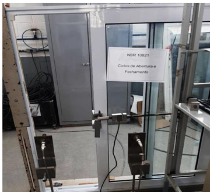
Foto n.º 05 – Visualização do ensaio comportamento sob ações repetidas de abertura e fechamento.
