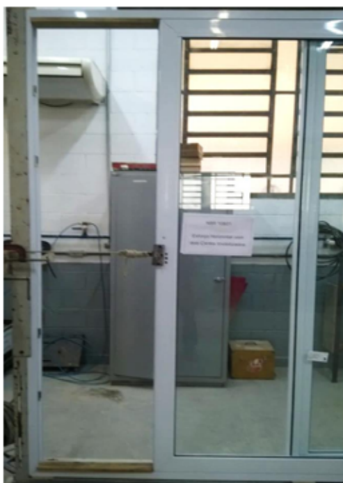
Foto n.º 07 – Visualização do ensaio de esforço horizontal com dois cantos imobilizados
