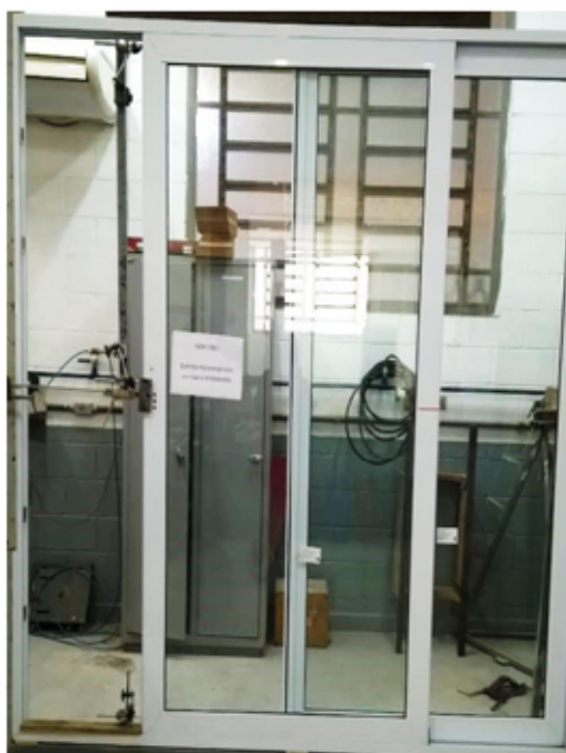
Foto n.º 06 – Visualização do ensaio de esforço horizontal com um dos cantos imobilizados.
