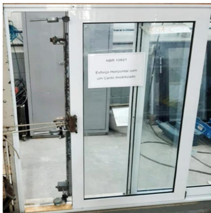
Foto n.º 06 – Visualização do ensaio de esforço horizontal com um dos cantos imobilizados.
