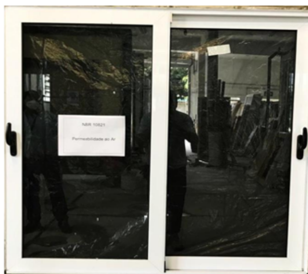
Foto n.º 01 – Visualização do ensaio de permeabilidade ao ar.
