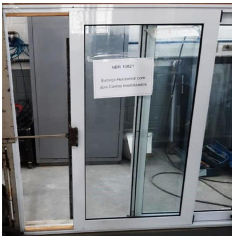
Foto n.º 07 – Visualização do ensaio de esforço horizontal com dois cantos imobilizados
