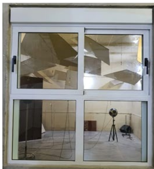
Foto 2 – Janela vista da câmara de recepção.
