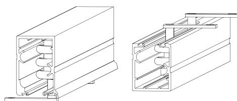
**04** Colocar os estacionamentos (J) no trilho superior e inferior fixando de acordo com a quantidade de vidros no sistema.
