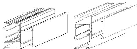
**17** Limpar a lateral do vidro com álcool isopropílico e colar o perfil de silicone (R) com silicone neutro 100%.
