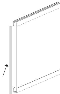
**18** Instalar o perfil “U” (F) e cantoneira (G) nas laterais do sistema, e colar a escova de vedação para um melhor acabamento e proteção.
