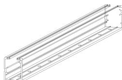
Antes da colagem do vidro no leito, limpar com álcool isopropílico. Aplicar um cordão de selante nas duas paredes do leito e verificar os esquadros.
