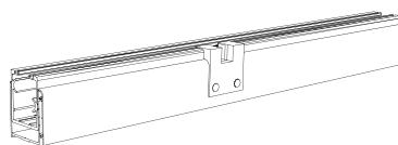
**16** Instalar a capa de acabamento (E) no perfil “U” de regulagem (A) superior e inferior.
