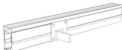
**11** Encaixar o trilho inferior (B), fixar os vidros nas roldanas e instalar a roldana dupla de regulagem no leito superior e pino guia no leito inferior.
