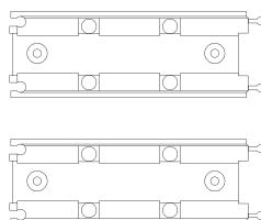
**05** Encaixar os Kits batentes (H) no trilho superior (C) e no trilho inferior (B), mantendo a distância de 10mm da ponta do perfil até o início da base do pivô e fixar bem, evitando futuro deslocamento.
