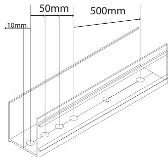
**Atenção:** O perfil U superior e o perfil U inferior devem estar precisamente no prumo entre si.
