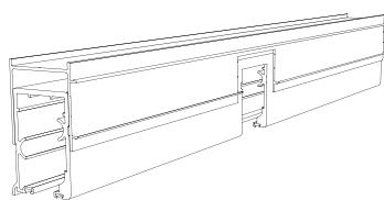
**09** Rebitar o trilho superior (C), sendo o primeiro rebite a 10mm da parede. Na sequência, rebitar a cada 100mm na seção onde os vidros estarão estacionados e após a seção de saída, continuar rebitando a cada 200mm.
