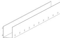
Fazer o dreno de água no trilho inferior, utilizando broca de 6mm e fazer a furação a cada 1.000mm.
